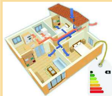
Schema di funzionamento impianto, Schema di funzionamento di un sistema di Ventilazione Meccanica Controllata.
